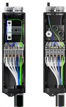
Завести в щиток провода питания светильника и заземления корпуса опоры через сальники, затянуть уплотнительные крышки сальников ключами №21. Подключить провода питания светильника;
